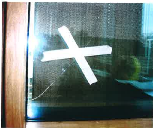
Figura 5. Rottura dovuta all'accumulo di calore in prossimità della superficie del vetro per la presenza del tendaggio interno
