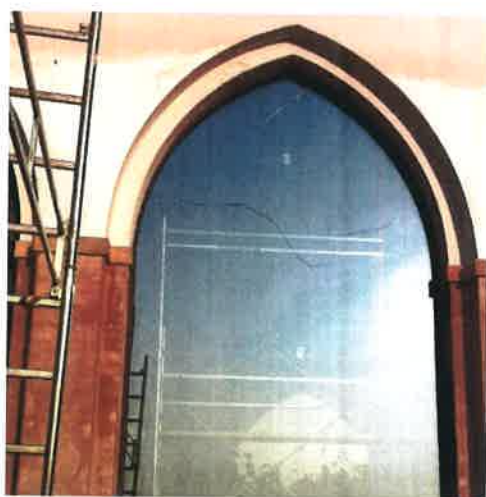
Figura 7. Difetti del bordo e ombre proiettate, tra cui quella del ponteggio, hanno contribuito alla rottura della vetrata
